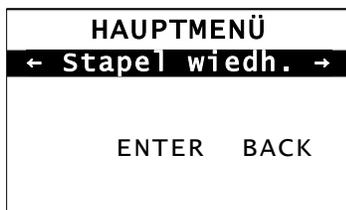
2. Drücken Sie **ENTER** (Eingabe), um den letzten Druckauftrag zu wiederholen. Der Wert wird erhöht, bis der gesamte Druckauftrag gedruckt wurde.
