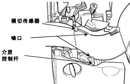
9. 握住打印头装置上的突起部分，按下打印头释放杆。
