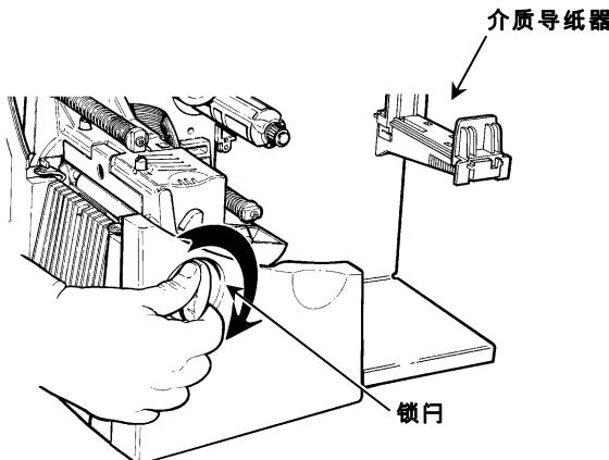
3. 使用打印头上的突起部分抬起打印头装置，直至打印头装置锁定到位。
