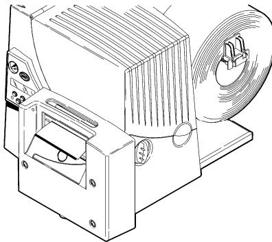
8. 调节介质导纸器，使它们恰好卡住介质。推起介质控制杆，锁定介质导纸器。
