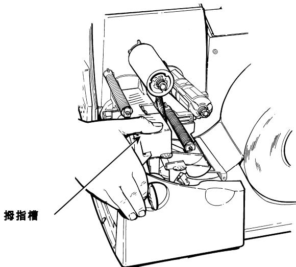
11. 按几次 **Feed/Cut** ( 送纸/切纸 ) 按钮，送出至少 3 个标签，以确保介质和色带安装在正确的位置。
