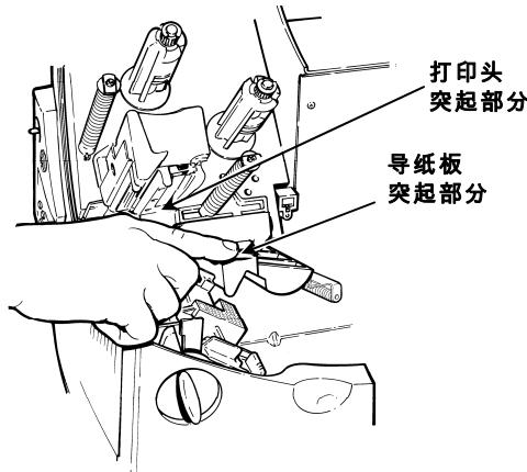
5. 将注有 "This End Out" (此面朝外) 的一面朝外，把多余的色带芯滑动到卷带盘上它所能达到的最远位置。使用空白色带芯作为卷带芯。卷带芯只能从一个方向安装到卷带盘上。
