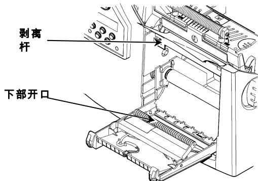
4. 将衬纸穿过退纸盖的下部开口。关闭退纸盖。向下拖拽衬纸，将纸拉平无褶皱。
