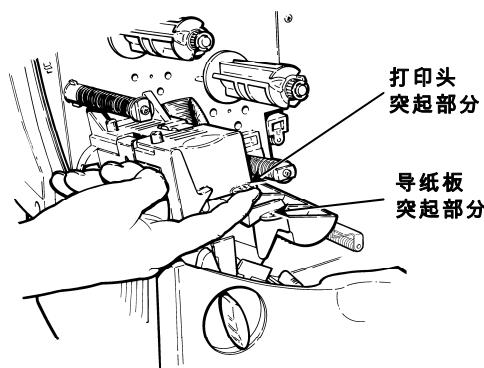
4. 将介质纸卷安装在标签固定器上。在打印标签时，整卷介质从顶部或底部展开。请不要握住标签固定器提起打印机。
