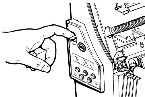
10. 按下拇指槽，直至听到咔哒声，使打印头回到关闭位置。
