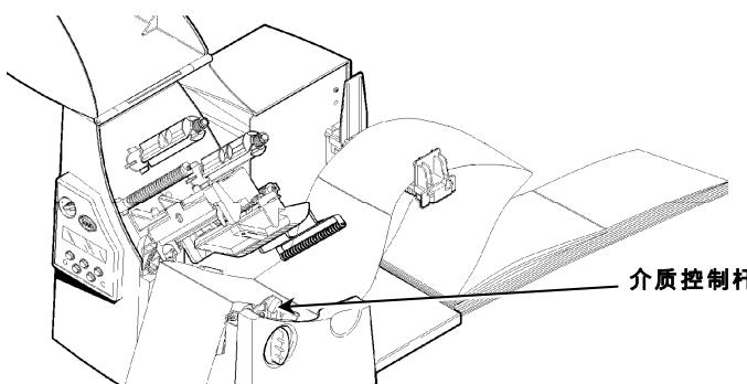
6. 按下介质控制杆，解除介质导纸器的锁定。
