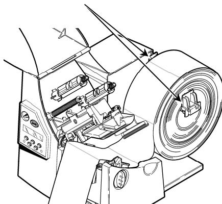
5. 调节介质固定器导纸器，使导纸器两侧恰好卡住纸卷。确保介质纸卷能够灵活转动。
