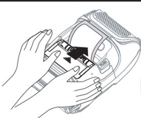
Con la bobina installata, far scorrere il corpo della pelatrice verso la parte posteriore della stampante.
