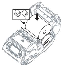
Inserire la bobina in modo che si srotoli dal fondo. Rimuovere il rotolo al centro della bobina quando questa è terminata.
