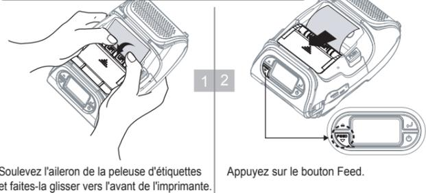
Soulevez l'aileron de la peelse d'étiquettes et faites-la glisser vers l'avant de l'imprimante. Appuyez sur le bouton Feed.
