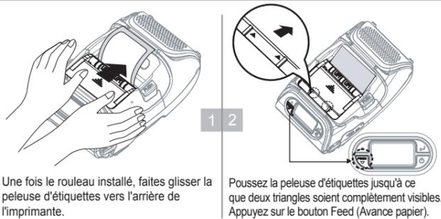
Une fois le rouleau installé, faites glisser la peelse d'étiquettes vers l'arrière de l'imprimante. Poussez la peelse d'étiquettes jusqu'à ce que deux triangles soient complètement visibles. Appuyez sur le bouton Feed (Avance papier).
