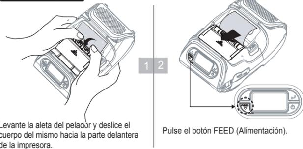
Levante la aleta del pelador y deslice el cuerpo del mismo hacia la parte delantera de la impresora.
