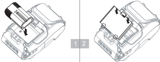
Extraiga la puerta de la batería. Inserte la batería como se muestra.
