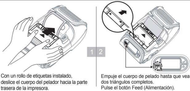
Con un rollo de etiquetas instalado, deslice el cuerpo del pelador hacia la parte trasera de la impresora.
