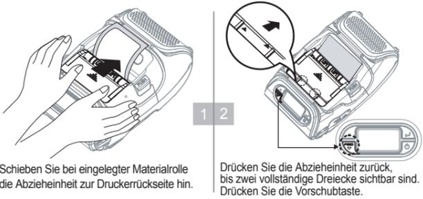
Schieben Sie bei eingelegerter Materialrolle die Abzieheinheit zur Druckerrückseite hin.
