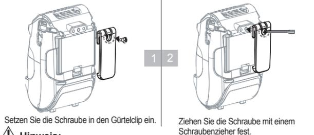
Setzen Sie die Schraube in den Gürtelclip ein.
