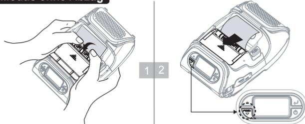
Klappen Sie den Abziehfügel nach oben und schieben Sie die Abzieheinheit zur Druckervorderseite hin.
