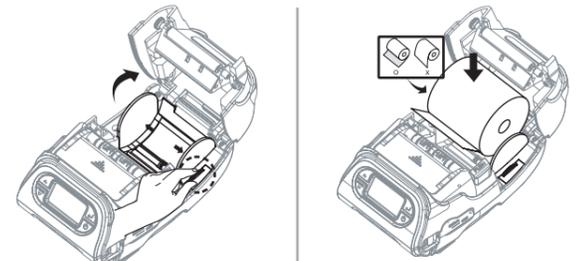
Öffnen Sie die Abdeckung und stellen Sie die Breite der Papierführung ein, indem Sie das Stellrad mit dem Finger drehen.
