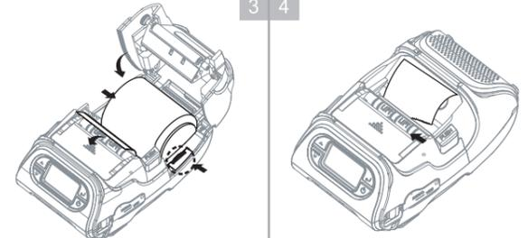
Ziehen Sie eine kurze Länge des Materials aus dem Drucker. Schließen Sie die Abdeckung.
