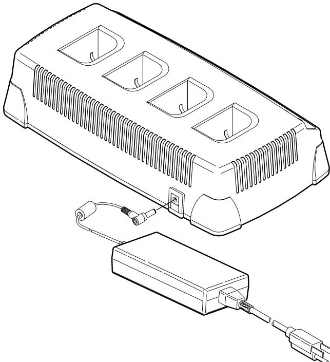
El LED de encendido se ilumina cuando el cargador está preparado y enchufado.
