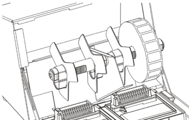
5. Coloque a guia de alimentação exterior no suporte de alimentação. Bloqueie a guia de alimentação exterior.
