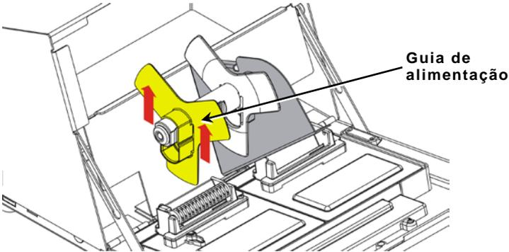
4. Coloque um rolo de etiquetas (com a etiqueta voltada para cima) no suporte de alimentação.
