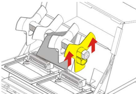
4. Coloque um rolo de etiquetas (com a etiqueta voltada para cima) no suporte de alimentação.
