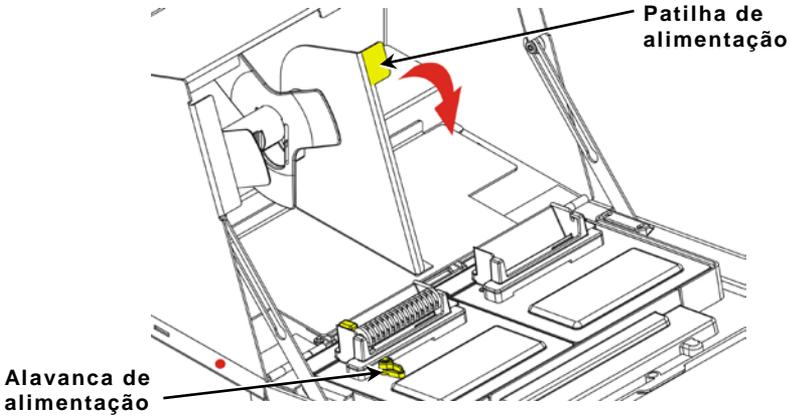
3. Desbloqueie a guia de alimentação. Remova a guia de alimentação do suporte de alimentação.
