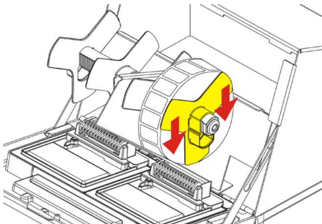
6. Desbloqueie a guia de alimentação interior. Mova a guia de alimentação interior até que o consumível toque na guia de alimentação exterior. Com a guia de alimentação interior a tocar no consumível, bloqueie-a no devido lugar.
