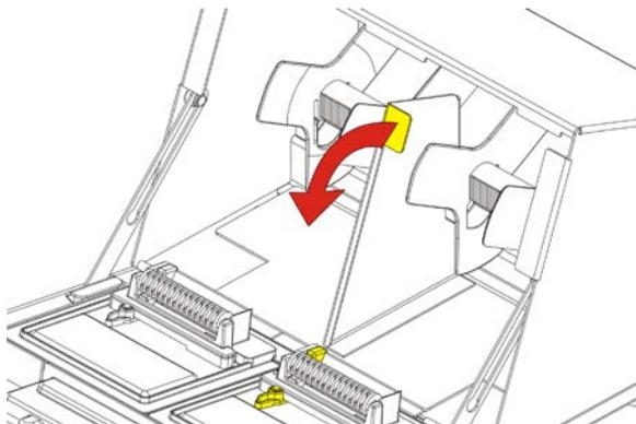
3. Desbloqueie a guia de alimentação exterior e remova-a do suporte de alimentação.
