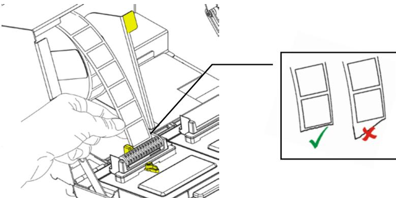
9. Deslize a alavanca de alimentação junto ao consumível. Feche a alavanca de alimentação.
