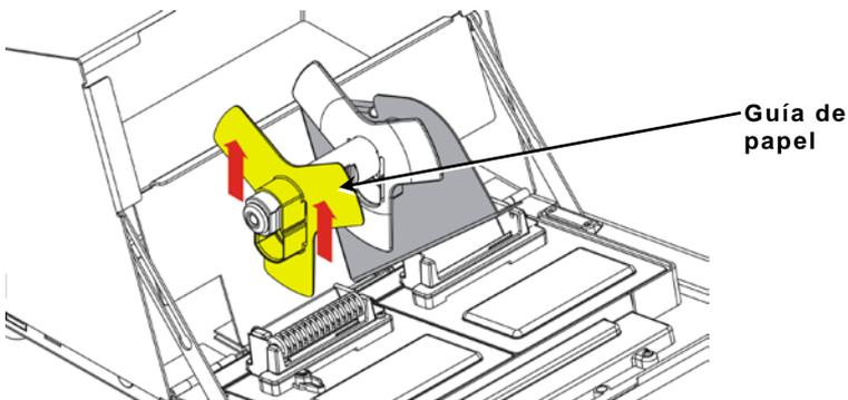
4. Coloque un rollo de etiquetas (con la etiqueta hacia arriba) en el sujetador de papel.
