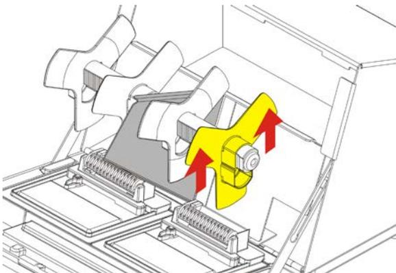
4. Coloque un rollo de etiquetas (con la etiqueta hacia arriba) en el sujetador de papel.
