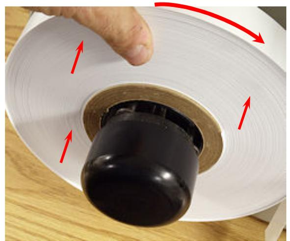
5. Drehen Sie den **Knauf der Materialaufnahme** im Uhrzeigersinn, um die Finger der Materialaufnahme, die das Etikettenmaterial festhalten, auszufahren. Damit wird das Material zentriert und auf der Aufnahme fixiert.
