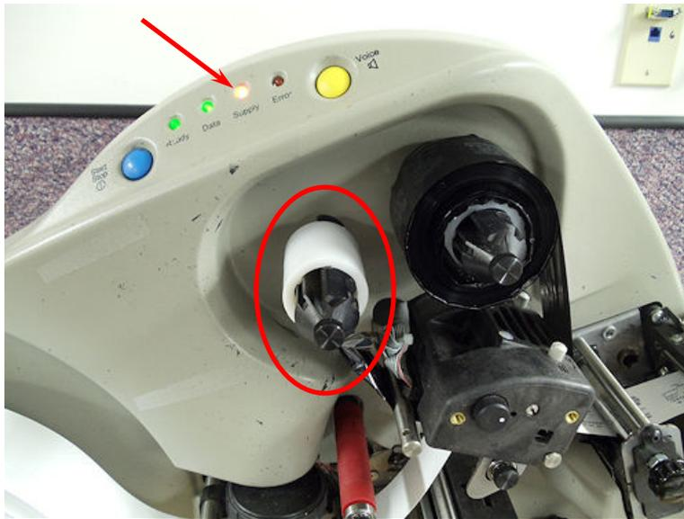
1. Öffnen Sie die **obere Druckrolle**. **Gegendruckwalze**.
