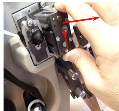
5. Reinigen Sie das Messer mit Alkohol und einem Wattebausch. Klopfen Sie mit dem Messer auf eine harte Oberfläche, um Schnittstücke zu entfernen.
