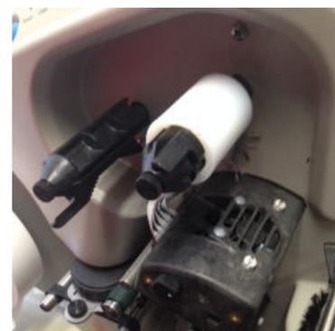
Entfernen Sie die Plastikverpackung von der Thermotransferfolie.
