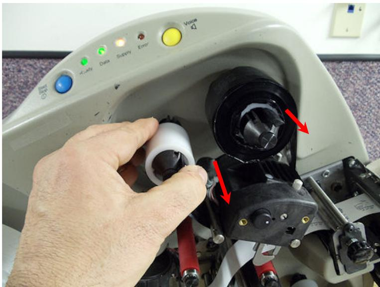
3. Installieren Sie einen leeren Folienkern auf der **oberen Folienaufwicklung (rechts oben)**.
