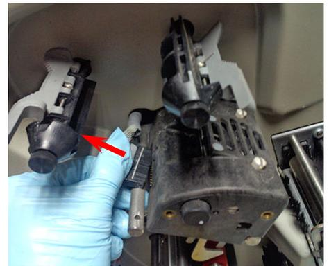
5. Drücken Sie die zwei grauen Klappen oben an der Druckstation. Fassen Sie darunter und ziehen Sie den Druckkopf aus der Druckstation.
