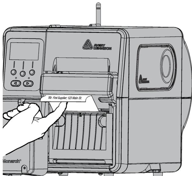
Lorsque vous retirez les étiquettes imprimées, soulevez-les toujours en utilisant le couvercle de la découpeuse comme guide.
