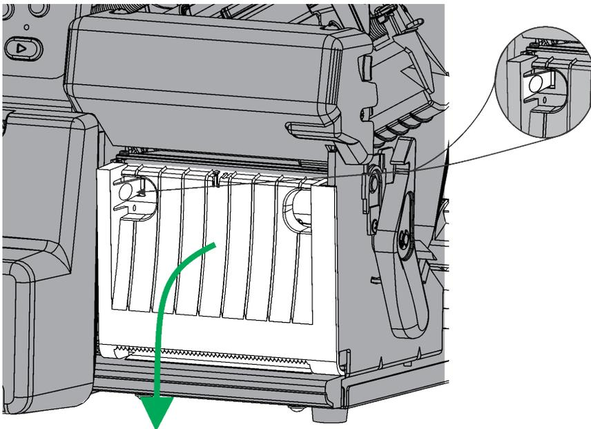
3. Utilisez vos ongles ou un tournevis à tête plate pour pousser le côté droit de la chute de décollement. Glissez cette extrémité vers l'extérieur et retirez le dispositif de chute.
