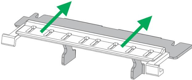
2. Assurez-vous que les languettes circulaires sur le guide d'alimentation pénètrent dans les rainures de la bordure de coupe.
