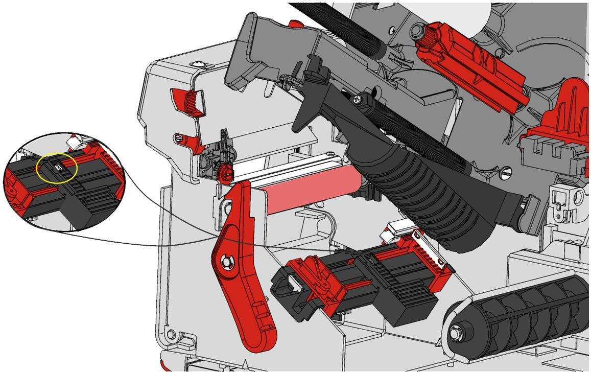
3. Utilisez l'extrémité en plastique du tampon d'élimination d'adhésif pour gratter l'adhésif détaché. Recueillez l'adhésif au moyen d'un chiffon en coton et jetez-le.
