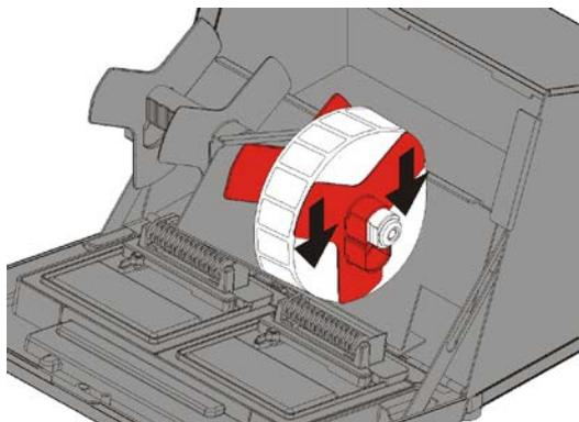
6. Освободите внутреннюю направляющую печатного носителя. Передвиньте внутреннюю направляющую печатного носителя, чтобы она касалась внешней направляющей печатного носителя. Зафиксируйте внутреннюю направляющую печатного носителя в месте, где она касается печатного носителя.
