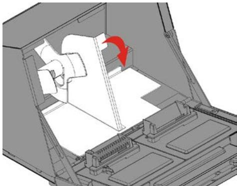
3. Освободите направляющую печатного носителя. Снимите направляющую печатного носителя с держателя носителя.
