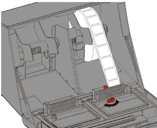
9. Передвиньте лепесток печатного носителя рядом с печатным носителем. Задвиньте рычажок печатного носителя.
