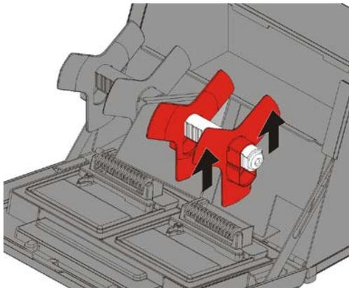
4. Coloque un rollo de etiquetas (con las etiquetas hacia arriba) en el soporte de suministro.
