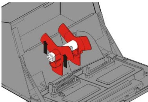
4. Coloque un rollo de etiquetas (con las etiquetas hacia arriba) en el soporte de suministro.
