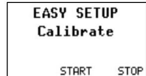
9) Press **START** (Iniciar) para calibrar. Al menos una etiqueta se alimenta en el proceso de calibración.
