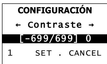
5. Pulse ← o → para aumentar o disminuir el contraste. La impresión se oscurece al aumentar el valor de contraste, mientras que la impresión se muestra más clara al disminuir el valor de contraste.
