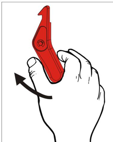
3. Levante el conjunto del cabezal de impresión hasta que se bloquee en su sitio.
